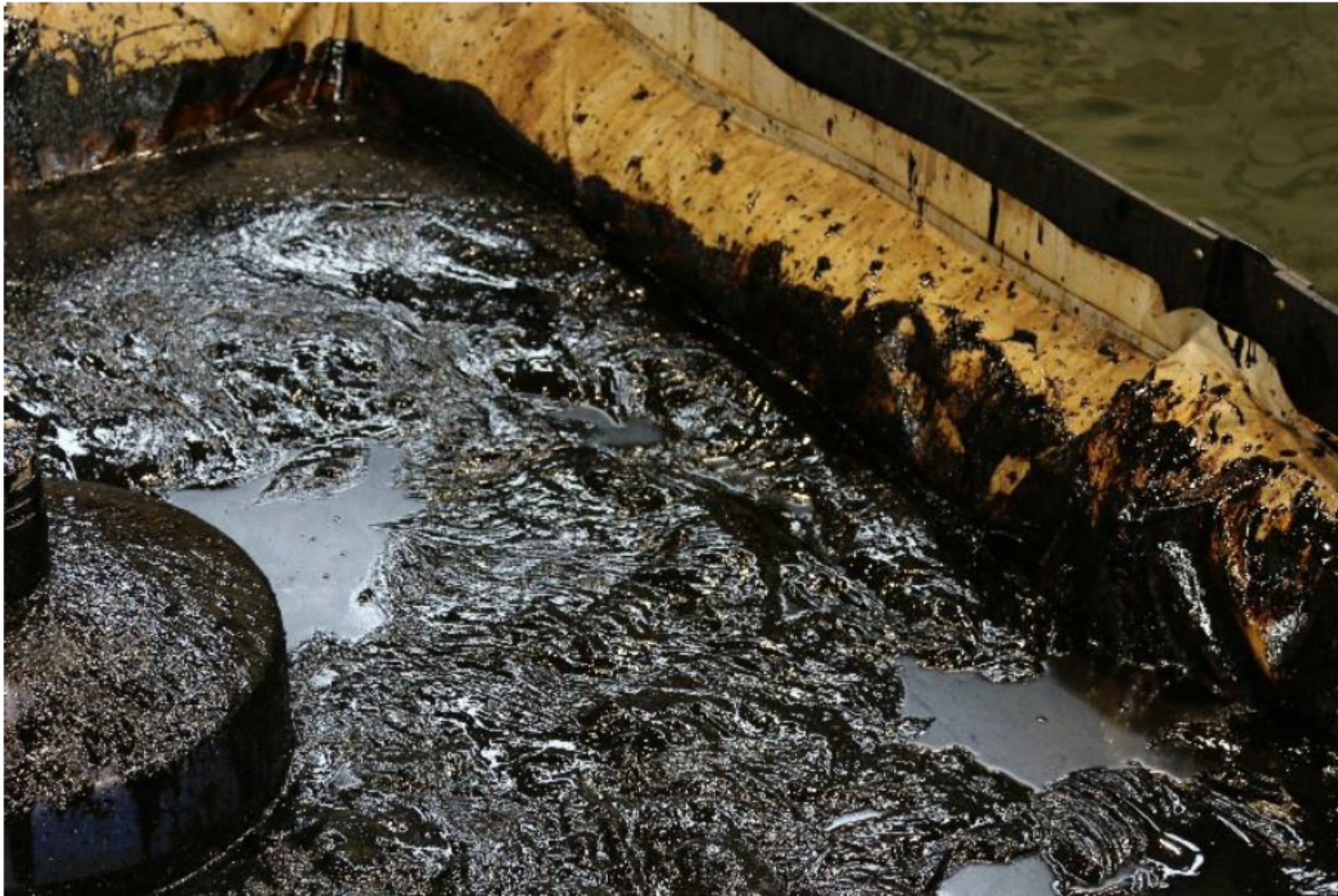
Bilde 3 viser at Shell ULSFO ikke flyter sammen og tetter hullene med vann
